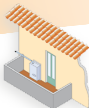
Installazione ad altezza parapetto
